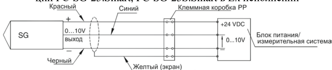
Рисунок 3 – Схема электрических подключений преобразователей модификаций PC-SG-25, PC-SG-25S с выходным сигналом от 0 до 10 В
