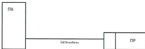
Рисунок А.5 - Схема включения преобразователей с выходным цифровым сигналом протокола Modbus RTU при определении основной погрешности и вариации
