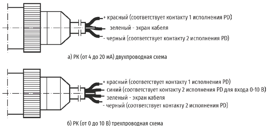
Рисунок Б.2 - Схемы электрических подключений преобразователей исполнений РК
